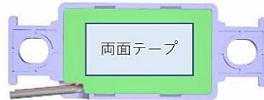
車載用の強力両面テープなど使用
