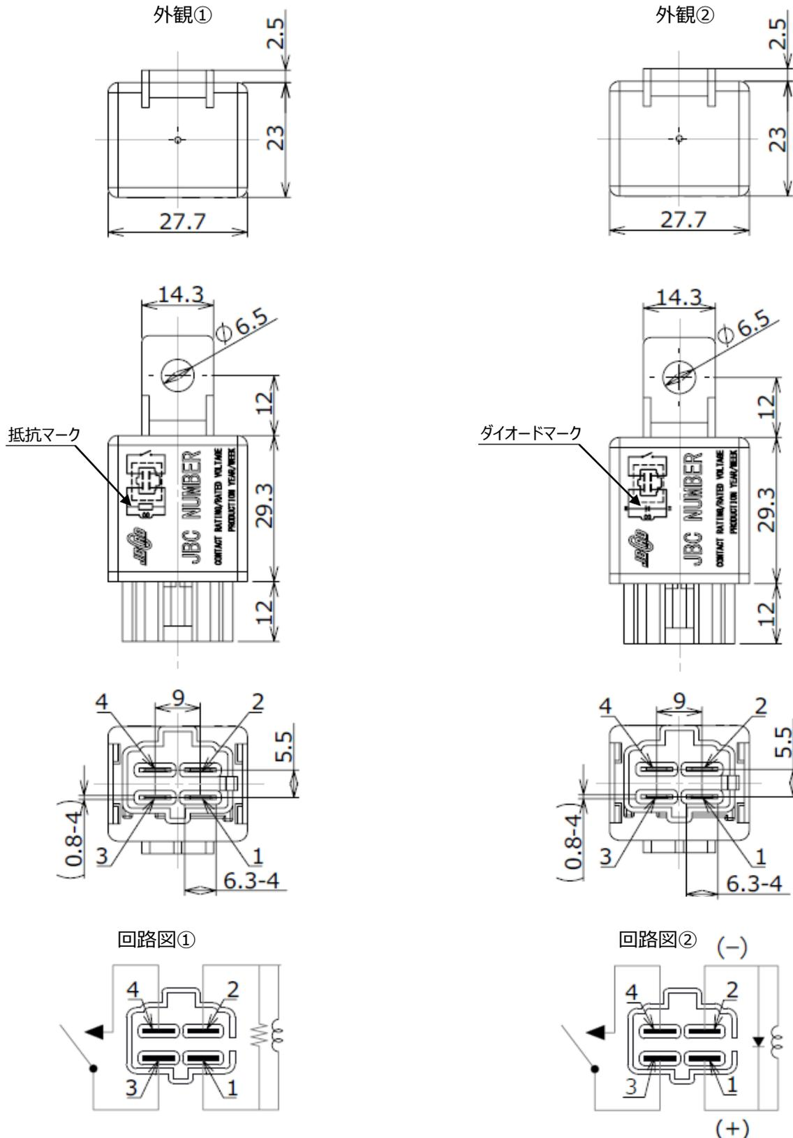
定格電圧12VDC品 コイル1/2W680Ω抵抗並列接続
